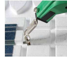
用x-net热切割机轻松创建管道通路
